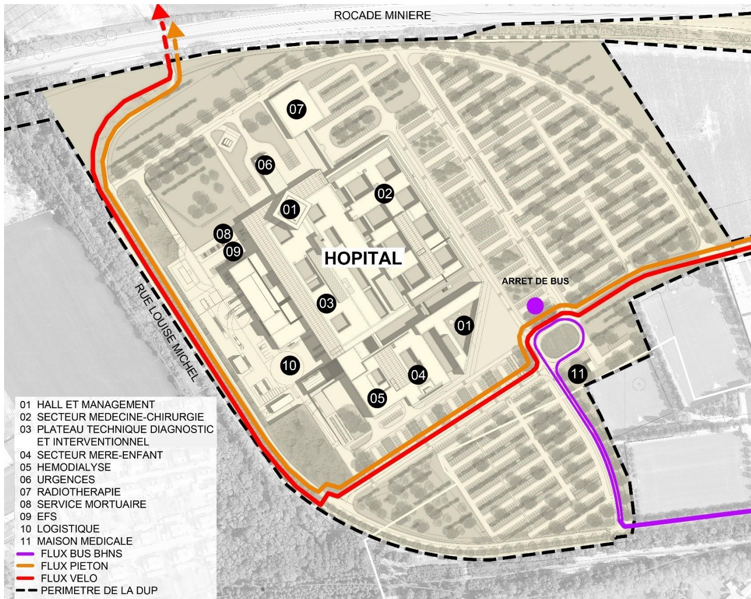
Plan masse du nouvel hôpital de Lens— Architectes Michel Beauvais Associés (MBA) Avril 2017
