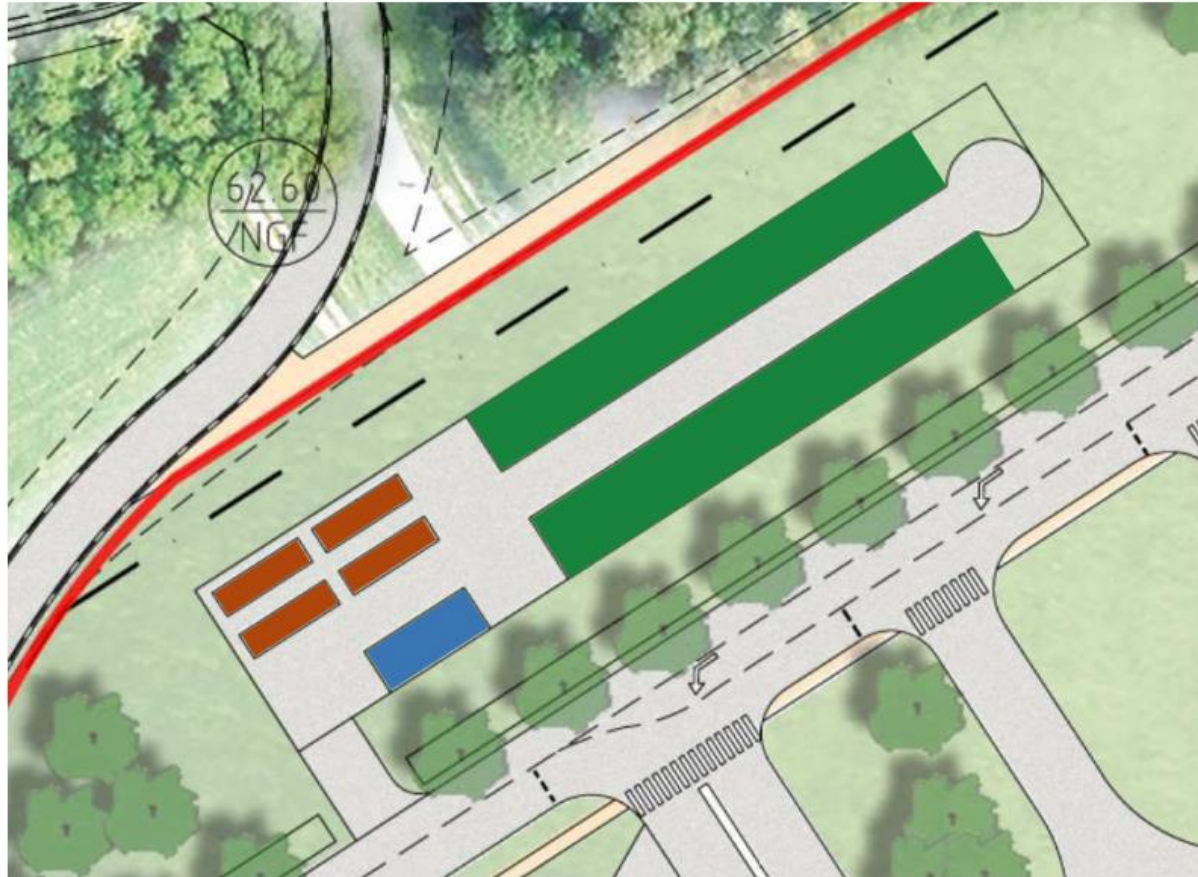
Solution bio-disques et roseaux : implantation prévisionnelle des différents ouvrages
